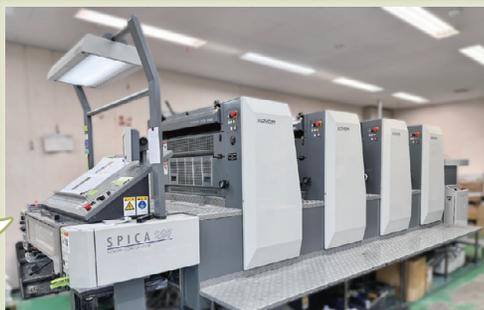
コジマではKOMORI社のオフセット印刷機「SPICA 29P」を使用しています。
